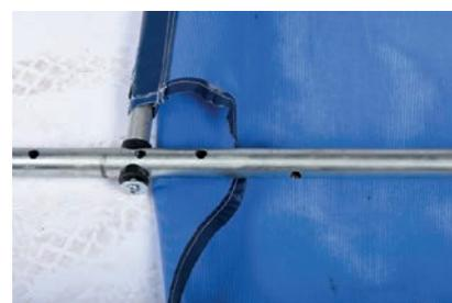
(12) Enfiler l'ensemble dans les trous du châssis et passer les boulons lorsque les perçages sont alignés.
