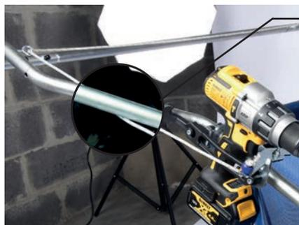
(27) Vérifier que la corde de commande passe sous le demi-manche droit afin d'exercer une action correcte sur la gâchette de la perceuse-visseuse.
