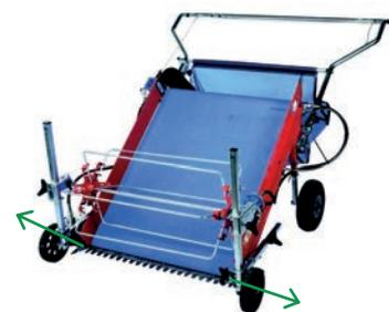
(15) Assembler le tube horizontal de la roue dans le tube avant de la machine : la vis étoile doit être orientée vers l'intérieur de la machine et la roue doit être à l'extérieur.
