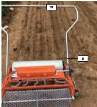
La barre de commande n°10 se règle en hauteur en plaçant les vis n°11 dans l'un des perçages des bras n°12.
