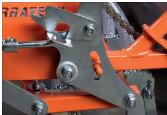
La barre de commande n°10 se règle en hauteur en plaçant les vis n°11 dans l'un des perçages des bras n°12.
