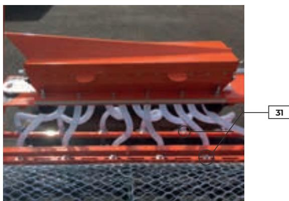
L'écart entre les rangs se règle en déplaçant les vis n°31 dans les trous oblongs du carter (utiliser une clé plate de 10mm).
