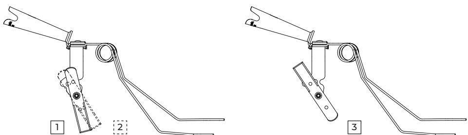
La position des lames peut être ajustée en fonction de l'angle d'attaque souhaité (position 1 ou 2). Il est également possible de travailler uniquement avec les ressorts en positionnant les lames vers le haut (position 3)
