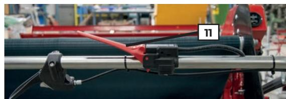
(30) Tourner l'arrêt d'urgence d'un quart de tour pour le déverrouiller afin de mettre la machine sous tension.
